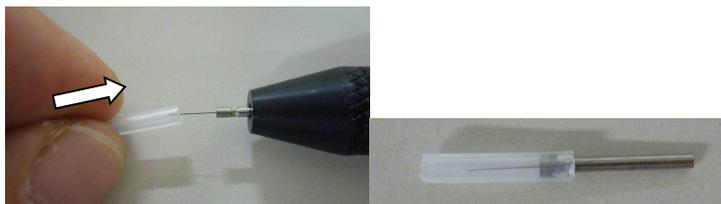
注：通電部は非常に細いため取扱は慎重に行ってください。曲がったりした場合は絶縁部分が剥がれた可能性があるため、新しい電極と交換してください。
